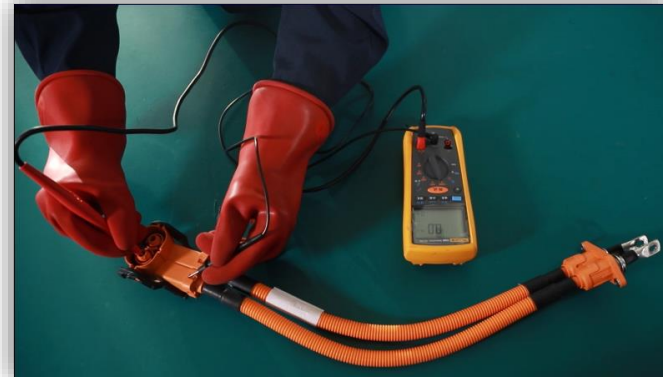
线束绝缘性测试
