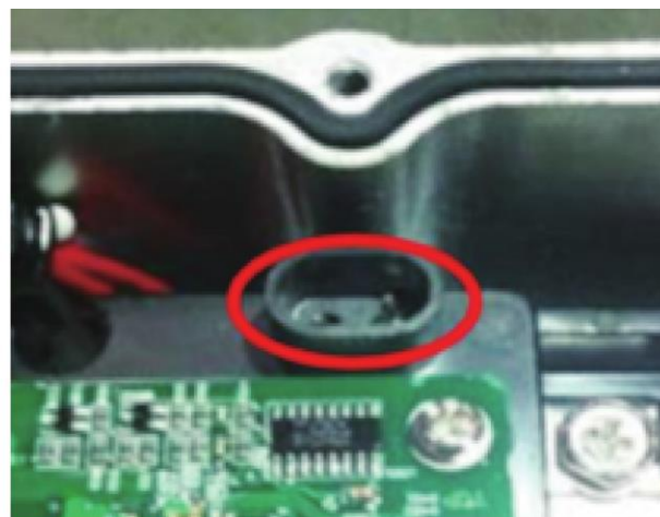
高压盒盖开关损坏
